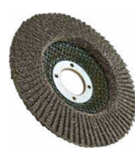
▲ Disco flap silício Mota Ø115mm Almofada de fibra de vidro Para desbastar e polir granito, mármore, vidro, cristal, plástico, fibra de vidro e tinta Grão 40 Ref. 39173 Grão 60 Ref. 39174 Grão 120 Ref. 39176
