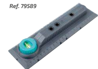
▲ Traçador Rubi Para fazer linhas perfeitamente retas em qualquer tipo de suporte Recipiente de plástico bi-matéria Carrete com 30m de corda Sistema de recolha rápida com bloqueio Embalagem de 120g de pó para traçar Ref. 79589
