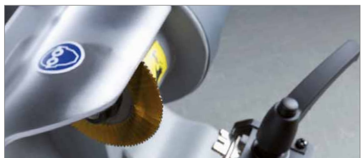
Fresa revestida TiN con cortes laterales
