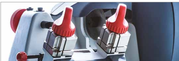
Mordazas rotativas de 4 lados, sinterizadas
